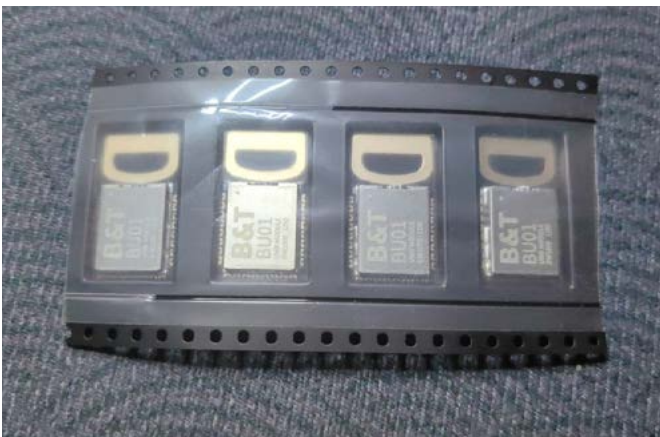
Figura 5. Módulos UWB BU01 (DW1000).
